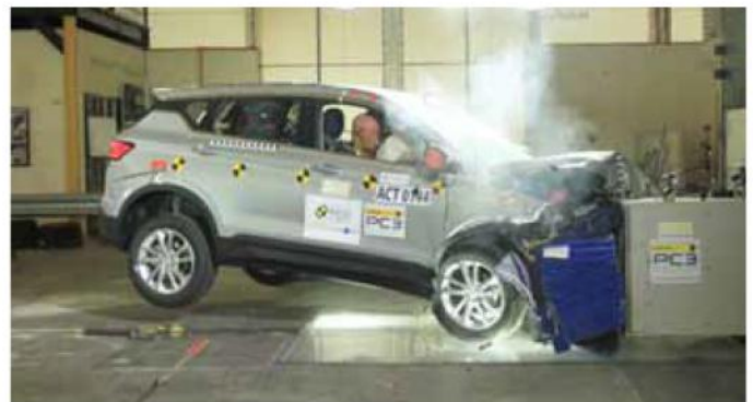
Fig 1: Ujian Perlanggaran ODB 64 bagi Proton X50
