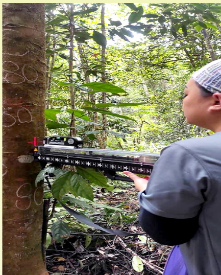
Rajah 2: Penggerudian pada dirian pokok menggunakan alat resistograph .
