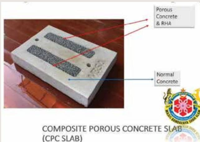
**COMPOSITE POROUS CONCRETE SLAB (CPC SLAB)**
